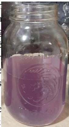
C'est de l'eau distillée et du jus de chou. Le pH de la solution est d'environ 7 et il est neutre.
